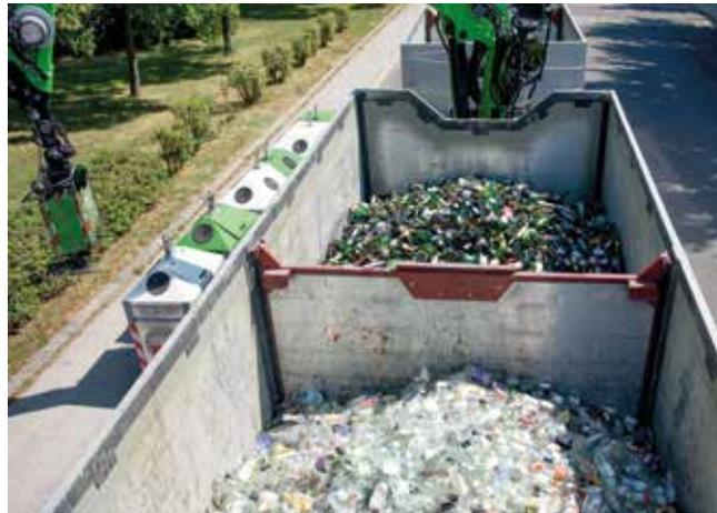
Bei der Entleerung von Altglas Behältern werden LKWs mit Zweikammersystemen verwendet. So bleibt Weiß- und Buntglas getrennt. Glas kann immer wieder in sehr guter Qualität recycelt werden.
